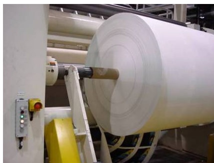
叉料叉臂将材料卸载到地上
