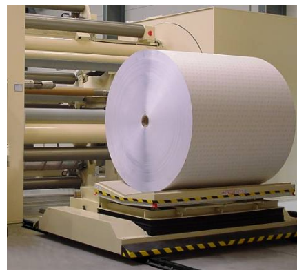
马达驱动卸载车作自动卸料处理
