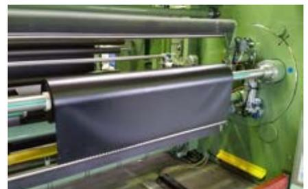
转盘式卷取机ATW-I系统中安装在转盘上的压制辊
