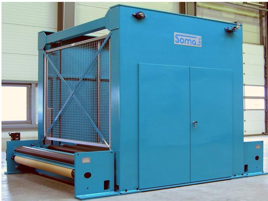
如果暂存器是通过气动驱动的，在正常操作（暂存器已存满材料）的情况下，可通过暂存器的高度控制牵引辊。
