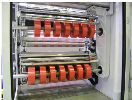
带摩擦轴的两站式复卷机
