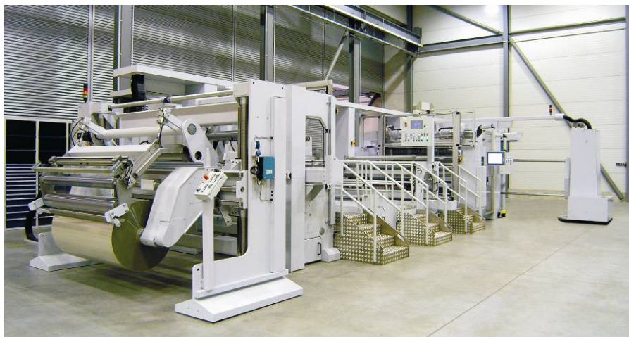
无尘室里用以分切和复卷纸张和薄膜的分切复卷机，
